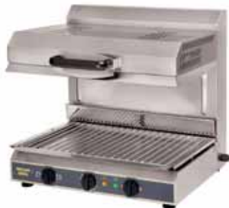
Salamandra, SEM 600 PDS Salamander with Plate Detection System Salamanders mit PDS Salamandre avec détection de plat Salamandra con PDS
